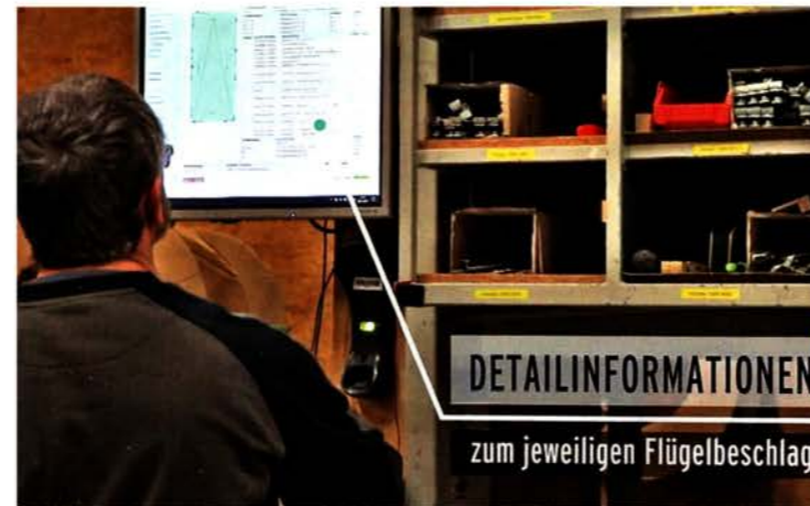
Welche Beschlagteile müssen an diesen Rahmen? Klaes e-prod liefert die Antwort nach einem Scan.
